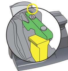
5.2 Heben Sie die obere Abdeckung der Frankiermaschine an und drücken Sie auf das Entriegelungssymbol zum Öffnen der Patronenverriegelung. Entfernen Sie das gelbe Verpackungsmaterial.
