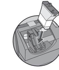
5.4 Tintenpatrone einsetzen. Setzen Sie bitte zuerst den unteren Teil der Patrone ein, bevor Sie die Oberseite nach hinten schieben.
