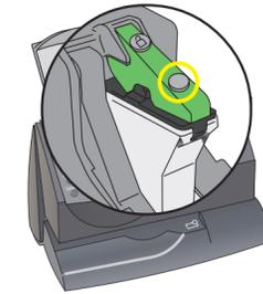
5.5 Schließen Sie die Patronenverriegelung wieder und drücken Sie an der Vorderkante, um die Tintenpatrone zu arretieren.
