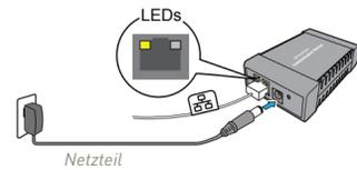
2. Schließen Sie das Netzteil an das Kommunikationsgerät sowie an eine Steckdose an. Die linke LED leuchtet **Gelb**, wenn es eingeschaltet ist.
