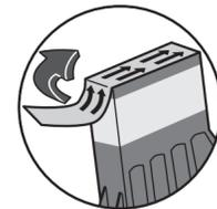
5.3 Als nächstes nehmen Sie die neue Tintenpatrone aus dem Kunststoffbeutel und entfernen die Schutzfolie auf der Unterseite der Tintenpatrone.
