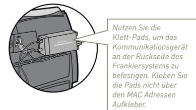
Nutzen Sie die Klett-Pads, um das Kommunikationsgerät an der Rückseite des Frankiersystems zu befestigen. Kleben Sie die Pads nicht über den MAC Adressen Aufkleber.
